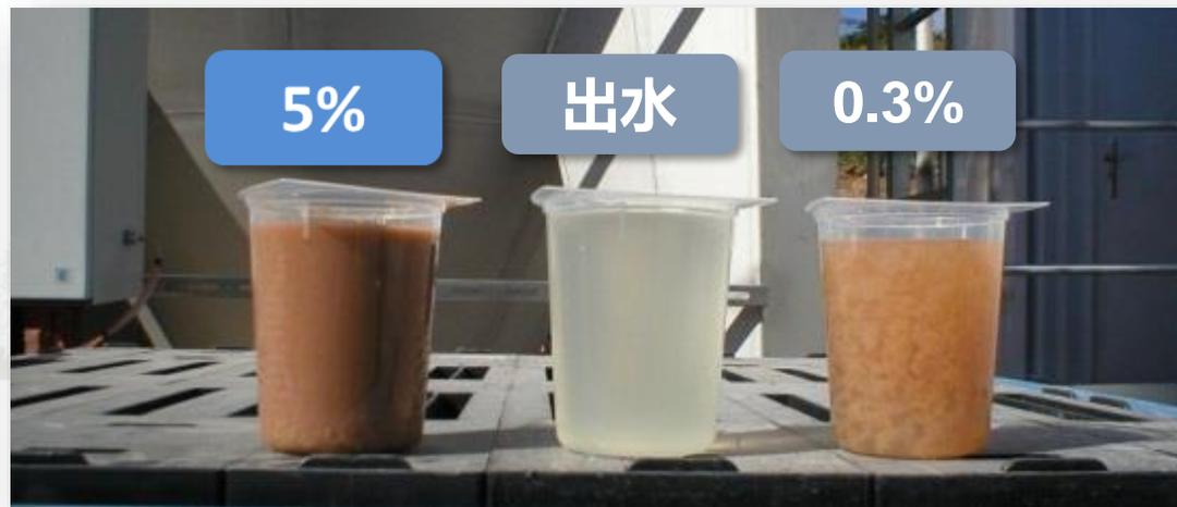
浓缩后的污泥含固率对于后续脱水设备的运行效率至关重要
