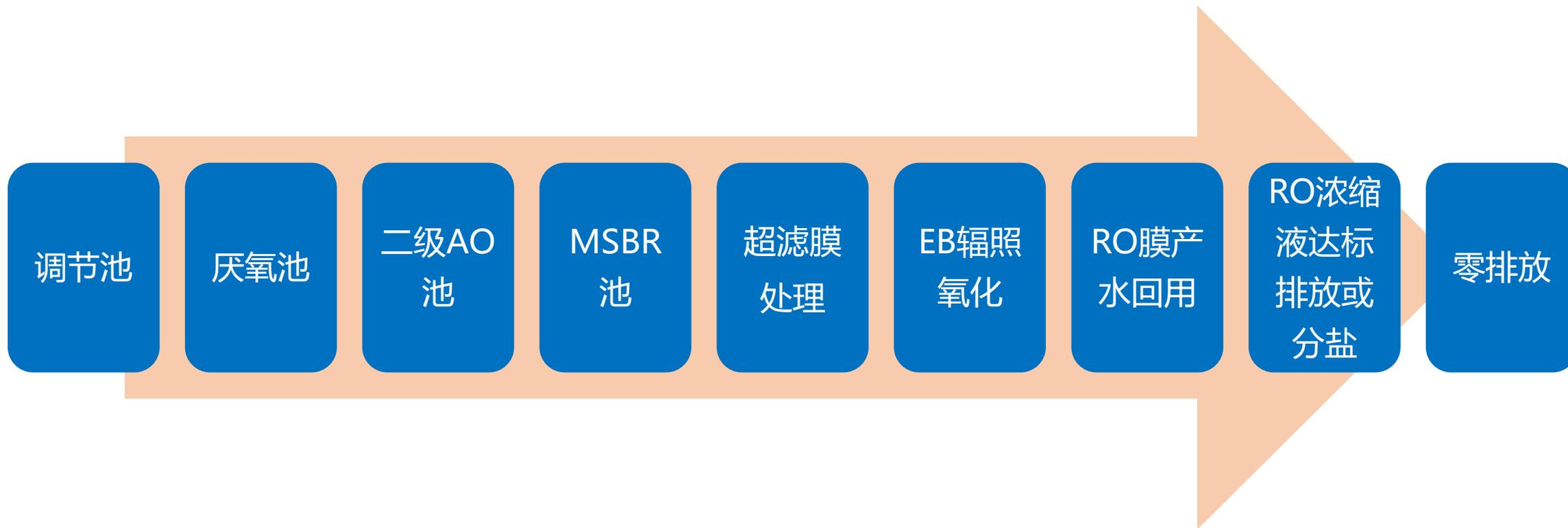
产水水质满足《城市污水再生利用 工业用水水质（GB/T 19923-2005）》冷却水标准
