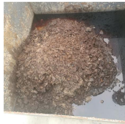
首钢垃圾焚烧厂项目残渣
