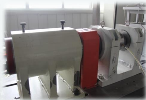
30000rpm径向 试验平台
