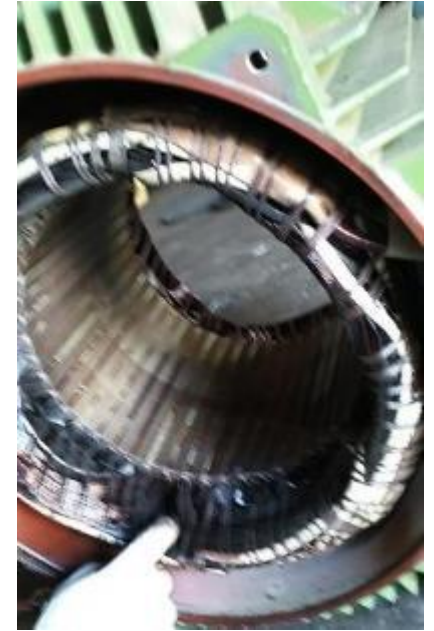
电机过热定子绝缘失效
