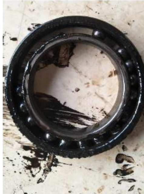
轴承保持架磨损直至滚珠掉落失效
