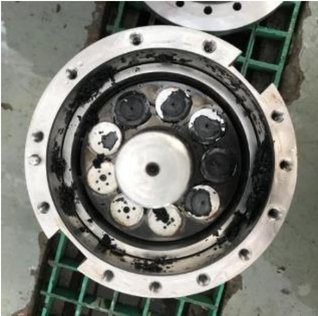
柱塞泵干磨导致滑靴、斜盘、回程盘等失效
