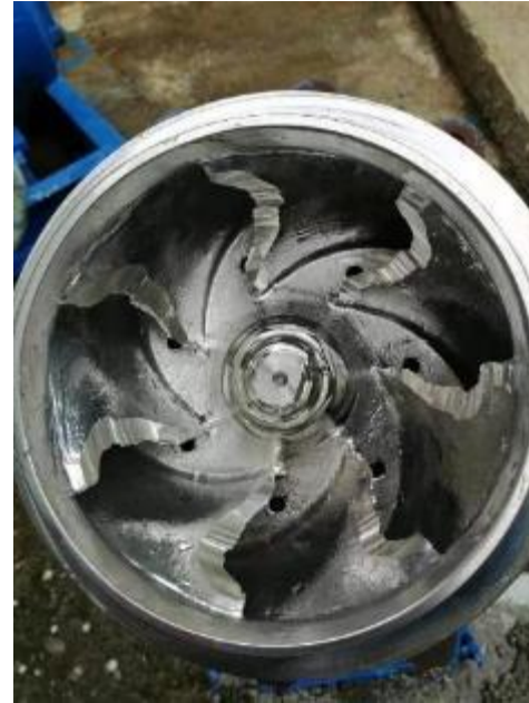
离心泵偏心不平衡导致叶轮损坏
