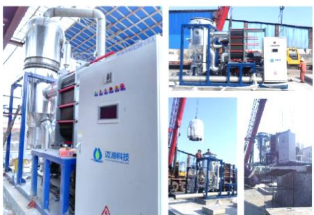
湿法冶金高盐废水 (蒸发量2t/h) 一体化MVR项目 ◆ 娄底新源有色科技有限公司
