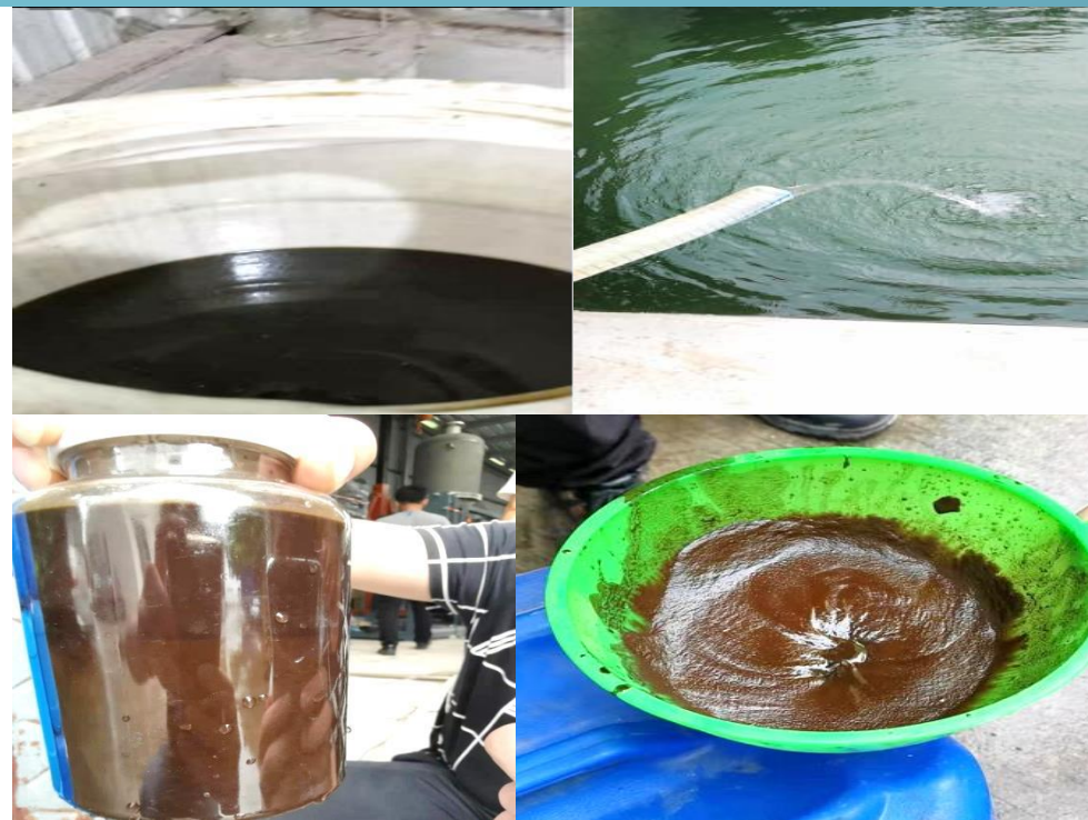
渗滤液蒸发处理后仅剩少许浓缩泥
