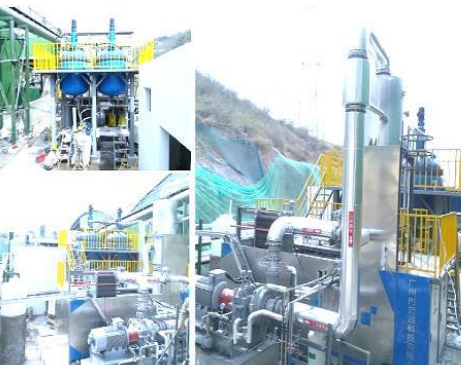
氯化钾和氯化铵杂盐废水 (蒸发量2t/h) 一体化MVR项目 ◆ 河南焦作
